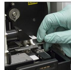
10. Remova o filtro do ventilador, lave-o bem com água morna, seque-o com uma toalha de papel e devolva-o para sua posição no analisador. Em seguida, na tela Guia de Limpeza SediVue Dx, toque em **Pronto** para ligar o SediVue Dx.
