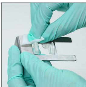
4. Usando um novo lenço de preparação de álcool, limpe bem o canal do cartucho e o braço de alimentação branco cuidadosamente. Em seguida, seque-os com um novo tecido óptico seco.
