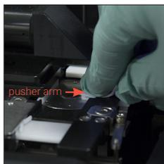
5. Pressione a alavanca do dispositivo empurrador para a esquerda e repita a etapa 4 no lado direito do braço empurrador usando um novo lenço de preparação de álcool enxaguado.
