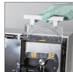
8. Usando um novo lenço com álcool (não enxaguado), limpe o braço de movimento e, em seguida, seque-o com um novo tecido óptico seco.
